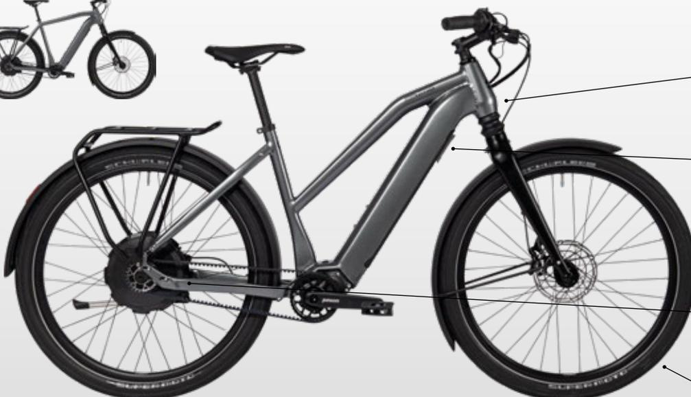
Aluminium-Rahmen mit integriertem Akku und verschiebbaren Ausfallenden
