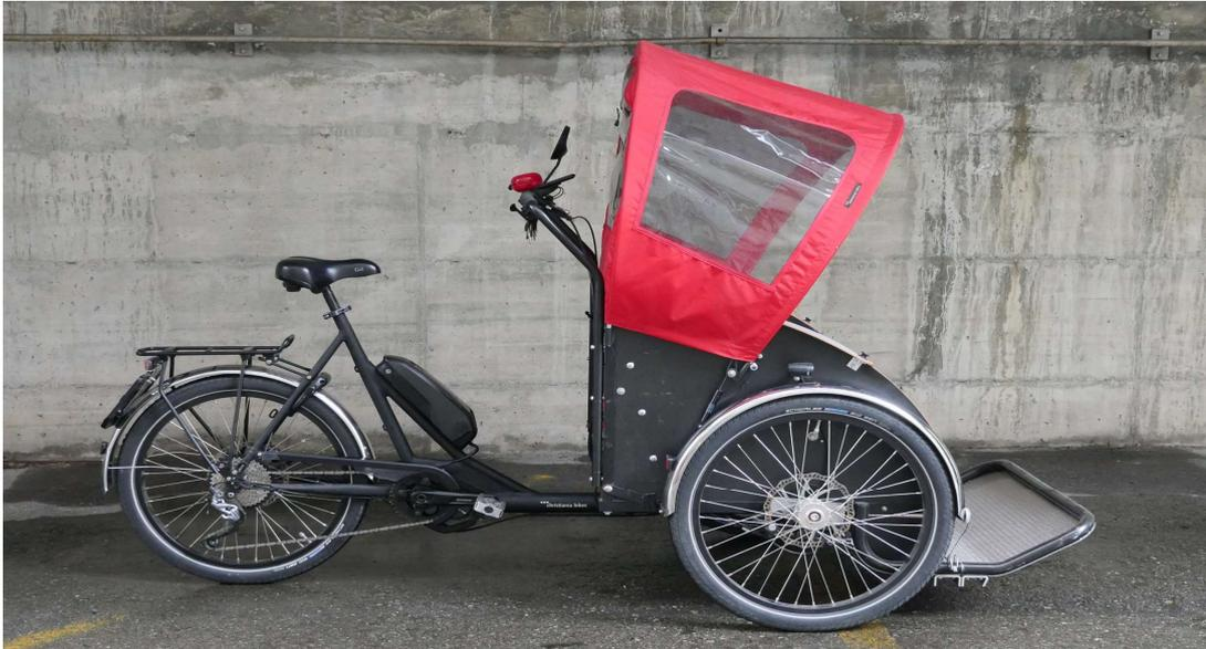
Aluminium-Rahmen, gepolsterte Sitze für bis zu zwei Personen, Sicherheitsgurte, absenkbares Fussteil, Beleuchtung, Schutzbleche, Rahmenschloss.
